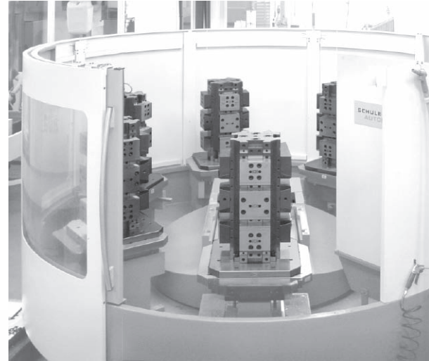
ВЕРТИКАЛЬНЫЙ ЗАЖИМНОЙ ЦЕНТР на карусельной палете для станков.
