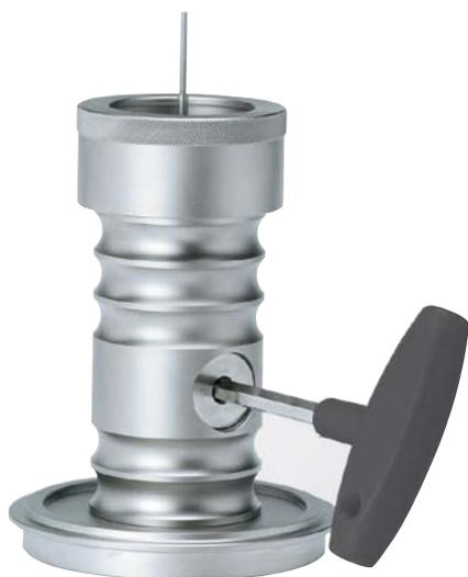
Устройство позволяет легко удалять сломанный инструмент из оправок. Инструмент можно извлечь даже тогда, когда линиялома находится внутри оправки. Базовую оправку можно адаптировать ко всем стандартным конусам шпинделя (HSK, SK, ABS) при помощи различных адаптеров. Даже если инструмент был установлен с большим натягом, хвостовик сломанного инструмента можно легко извлечь из термозажимного патрона. Прочие типоразмеры по запросу.
