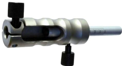
Устройство настройки вылета помогает точно настроить вылет режущего инструмента из термопатрона. Толкатель настраивается на требуемую величину и фиксируется. Затем следует вставить режущий инструмент в отверстие устройства, надавить на него, пока он не упрется в пластиковый упор, зафиксировать. Вместе с устройством установить режущий инструмент в термопатрон до упора.
