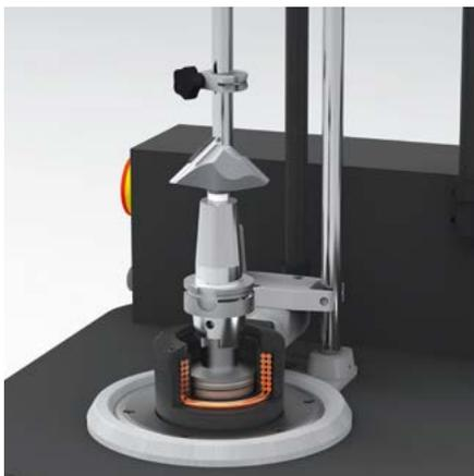
Рис. 1: Установка инструм. адаптеров
