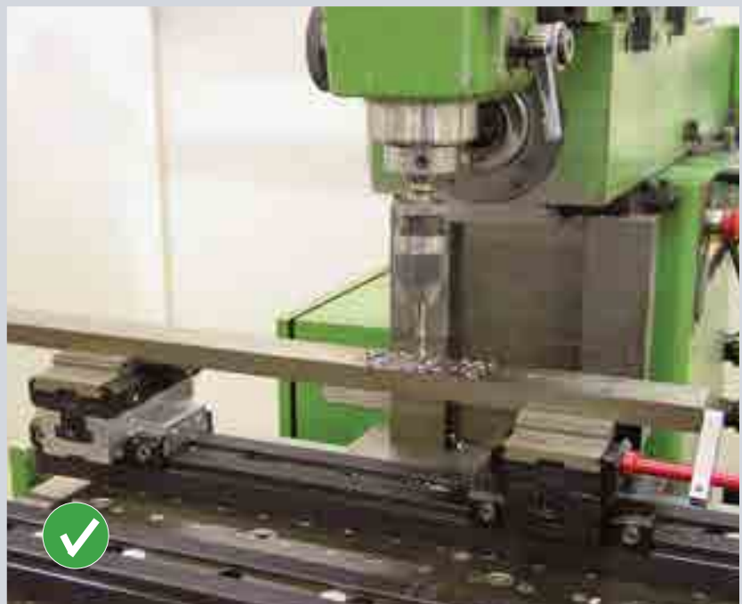
... после сверления стальной брусок, закрепленный в самоцентрирующихся тисках, можно перемещать с шагом 2 мм.
