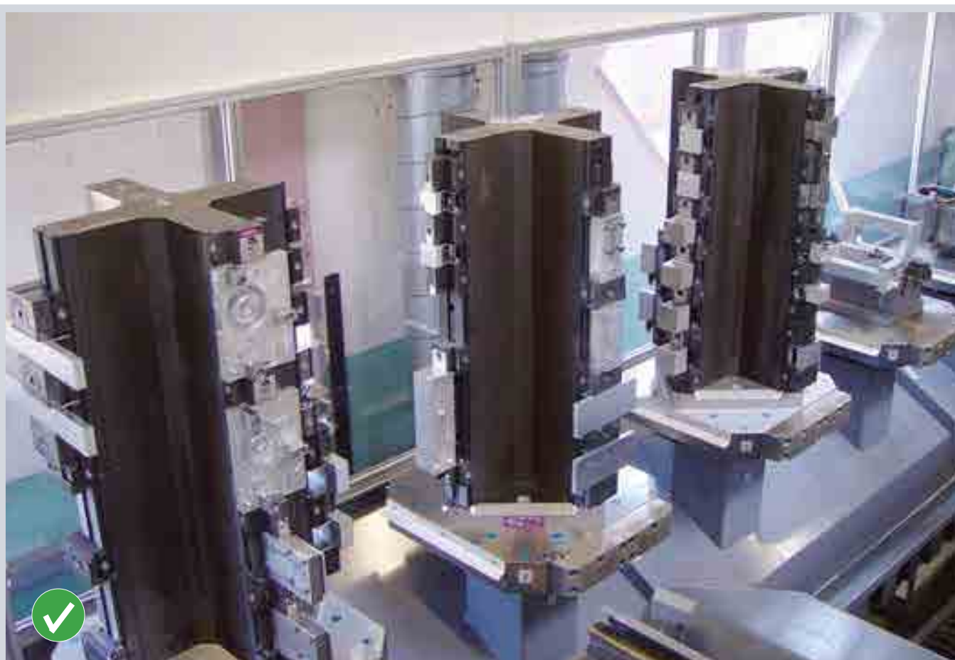
Смешанная партия деталей, закрепленная на горизонтальном станке Mazak с 18 паллетами. Используется для автоматизированной обработки небольших партий деталей из различных материалов.
