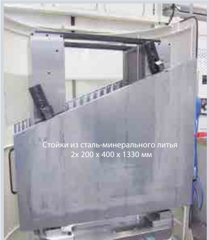
Стойки из сталь-минерального литья на производстве деталей крыльев самолета на станке Makino
