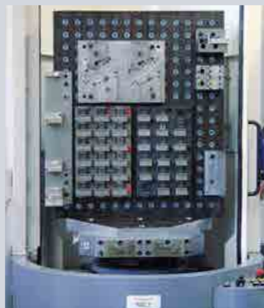
Высокая плотность крепежных отверстий на плите для обеспечения высокой плотности закрепления деталей
