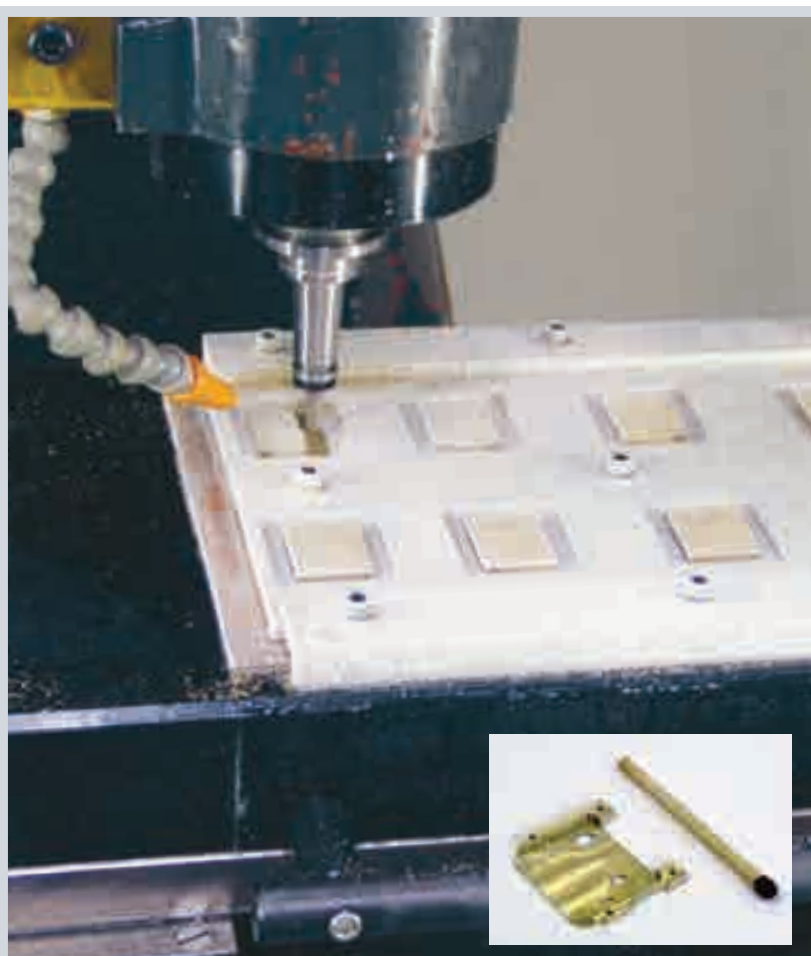
Пример закрепления методом замораживания: 2-е закрепление медного корпуса часов
