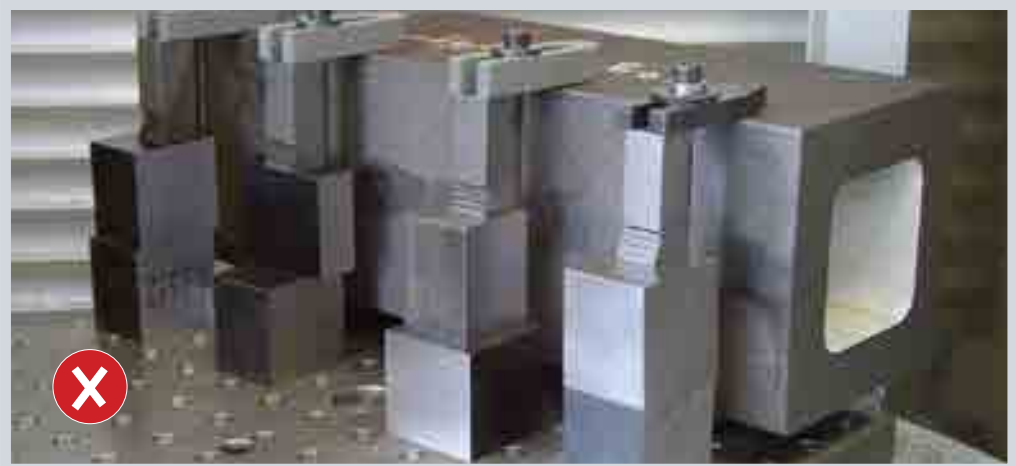
Плохой доступ к заготовке и незащищенный зажим
