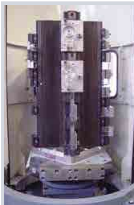
Смешанная партия деталей на стойке из минерального литья в форме креста
