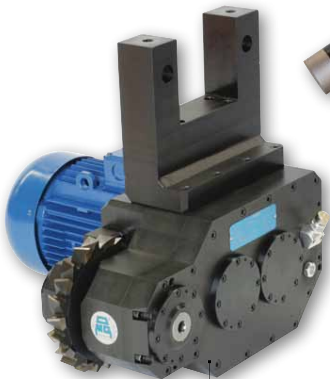
TFS 05609 Фрезерная угловая головка для вертикального токарного станка. Вес 286 кг.
