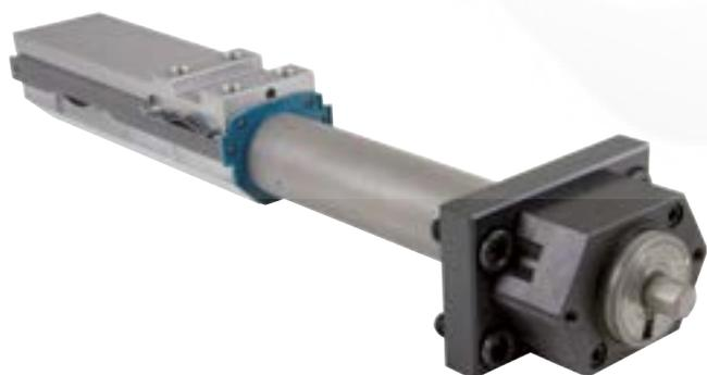
*Механический усилитель мощности*
